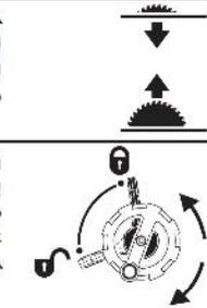
جهت چرخش پیچ آچار برای ثابت کردن/باز کردن راهنمای زاویه برش روی میز کشویی.
